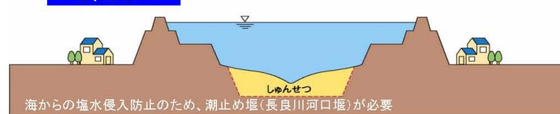
海からの塩水侵入防止のため、潮止め堰(長良川河口堰)が必要
