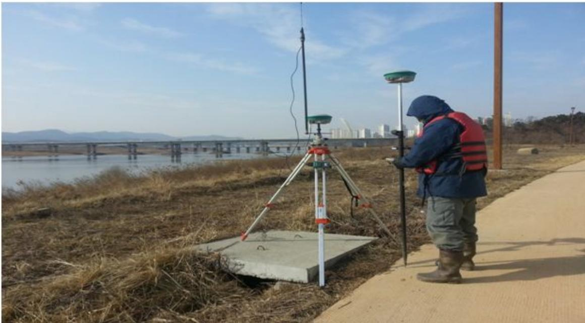
[그림 4-14] 세종보 기준점 설치 및 시험
