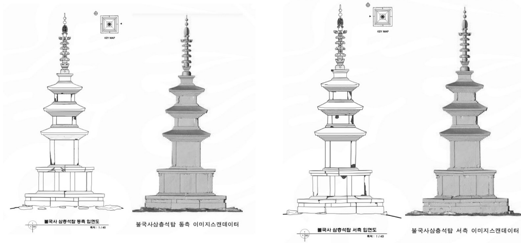
[그림 5] 불국사 삼층석탑 수실측 측면도 및 이미지스캔데이터
