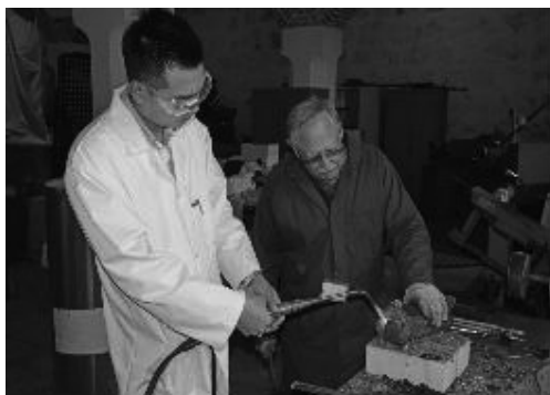
[사진 3] 불꽃을 이용한 표면 응결물 제거
