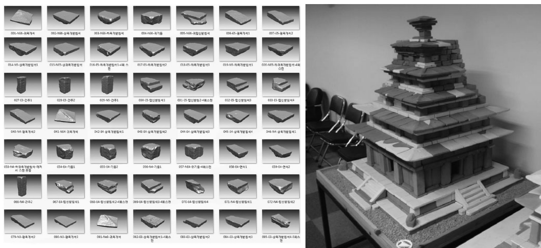
[그림 1] 미륵사지석탑 개별부재 스캔이미지(左)와 이를 바탕으로 제작된 모형(右)
