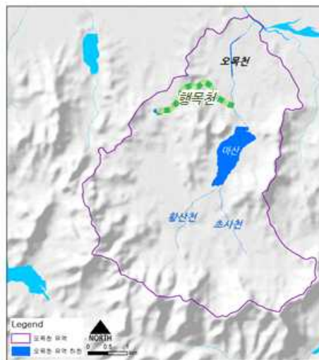
[그림 6-36] 행목천 식생수로 및 여과대 조성 위치(안)
