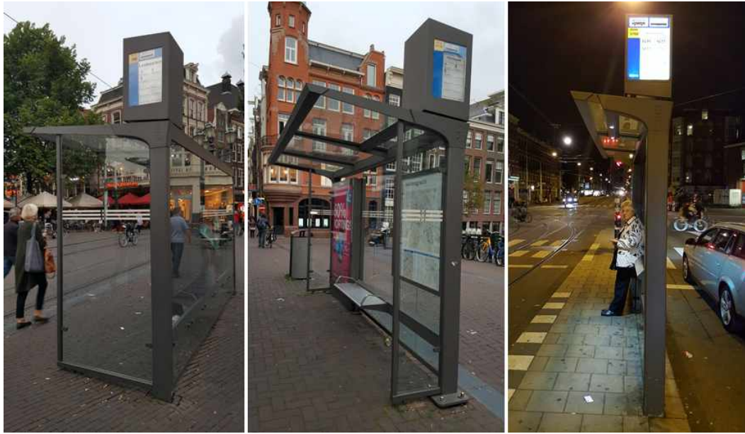
* 버스승강장 기본 (좌) / 측면 가림막을 줄임 (중) / 측면 가림막을 없애고 상단지붕(프레임)을 줄임 (우), 암스테르담
