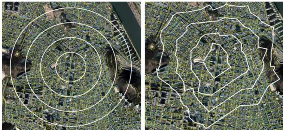
〈그림 32〉 도보 기준 접근성 분석 방식(좌), 차량 기준 접근성 분석 방식(우)
