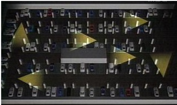
(그림3-1) 주차장에 설치된 CCTV가 주차통로만을 감시하고 있어 범행사각지대 발생(좌)
