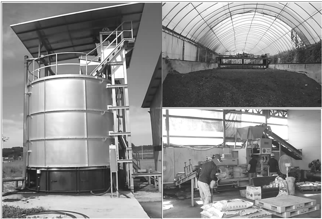
[그림 3-7] 가축분 건조 및 부산물비료 포장
