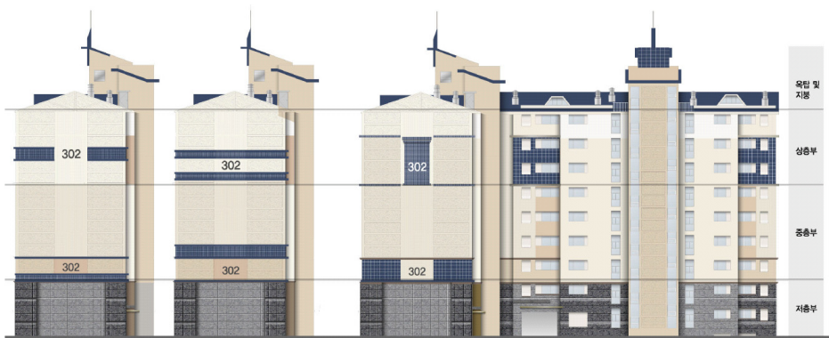
〈그림 4-50〉 공동주택벽면 태양열 집광(열)판 설치 예시도
