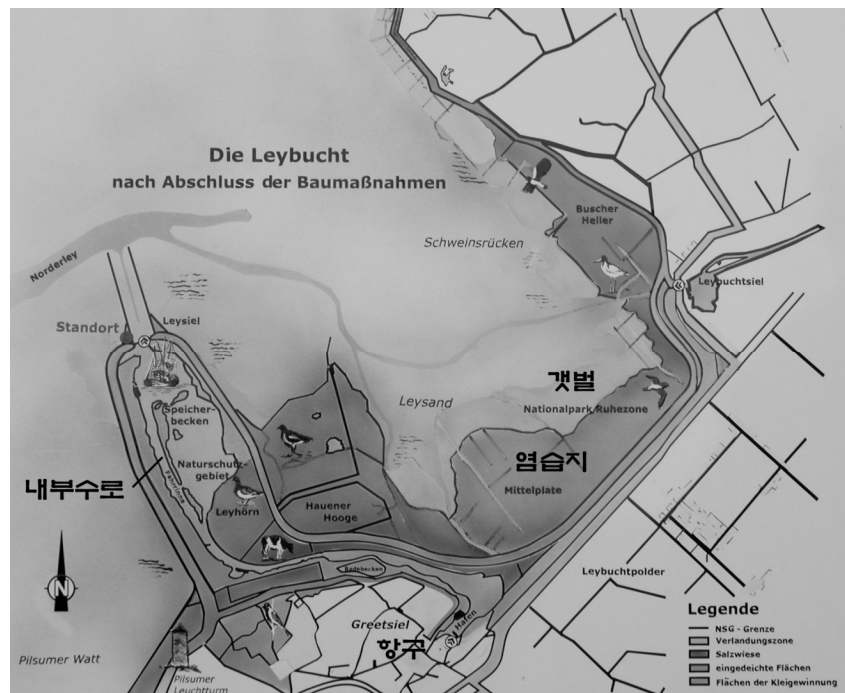
그림 19. 인공 방조제로 수로를 설치하고 내부에 기수역과 어항을 두었음. 독일의 라이부흐트만과 그릇질 항구.
