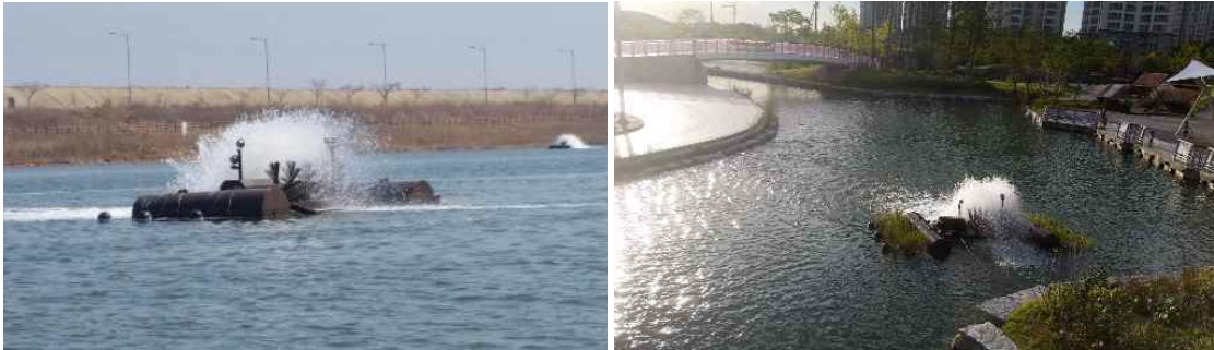
[그림 5-1] 흐름유발장치 설치모습(좌 : 당진시 석문호, 우 : 인천광역시 청라호수공원)
