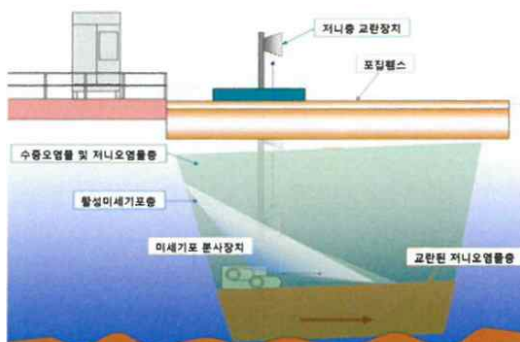
[그림 3-6] 이동식 가압부상 원리
