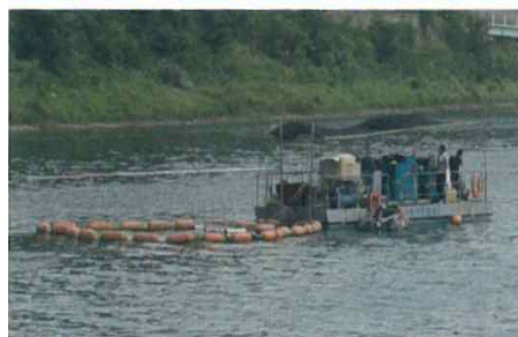
[그림 3-7] 이동식 가압부상 설치 모습
