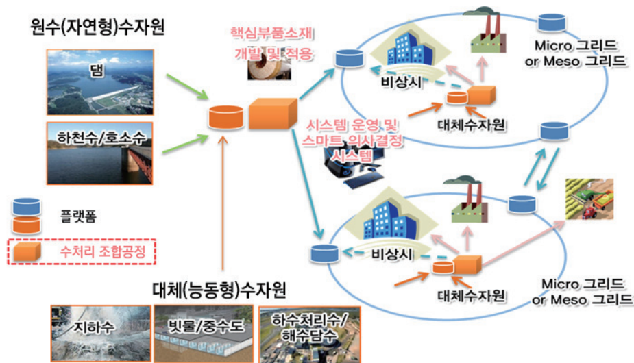
〈그림 3〉 다중수원 위터루프시스템 개념도
