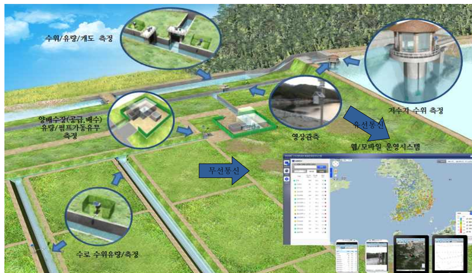
[그림 2-2-9] 농업용수 현장 제어/계측 시스템 구성 예시(한국농어촌공사, 2014)
