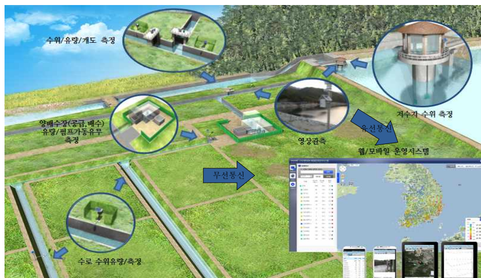
[그림 4-1] 농업용수 현장 제어/계측 시스템 구성 예시(한국농어촌공사, 2014)
