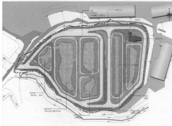
[그림 4] 논산시 양지리 인공습지 설계도
