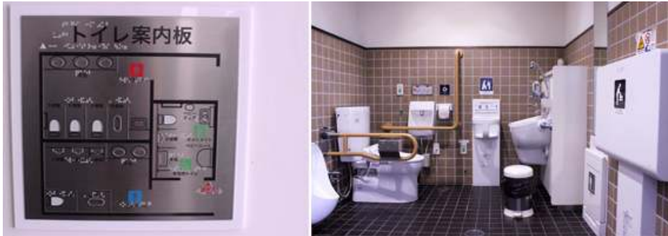
▲시각장애인들이 화장실을 이용하기 편리하도록 화장실 문 앞에 촉지도 설치(왼쪽) 다목적 화장실의 내부. 장루·요루 장애인을 위한 시설(오른쪽)
