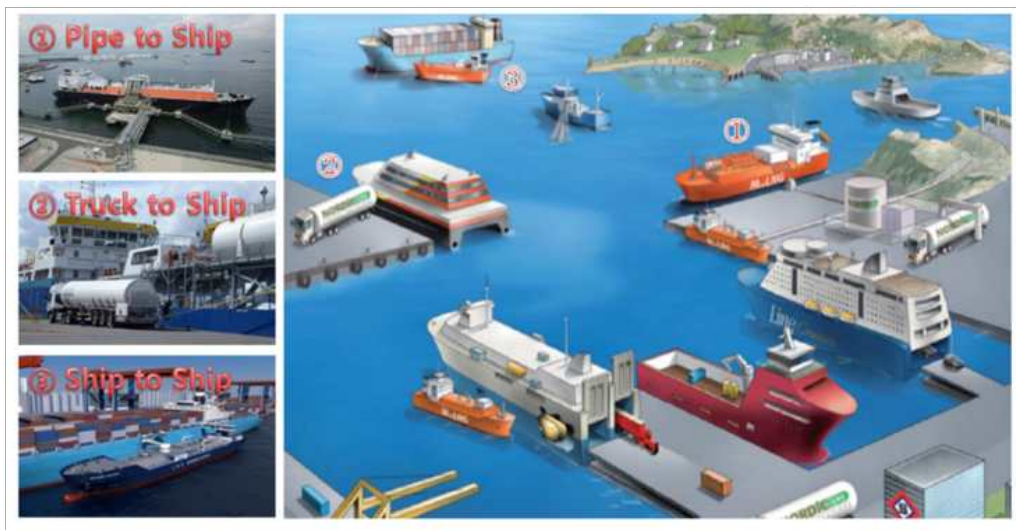
[그림 1-2-13] LNG 벙커링의 3가지 방법
