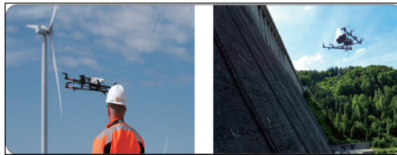
〈사진 16〉 드론을 이용한 시설물 관리(풍력발전소, 댐)
