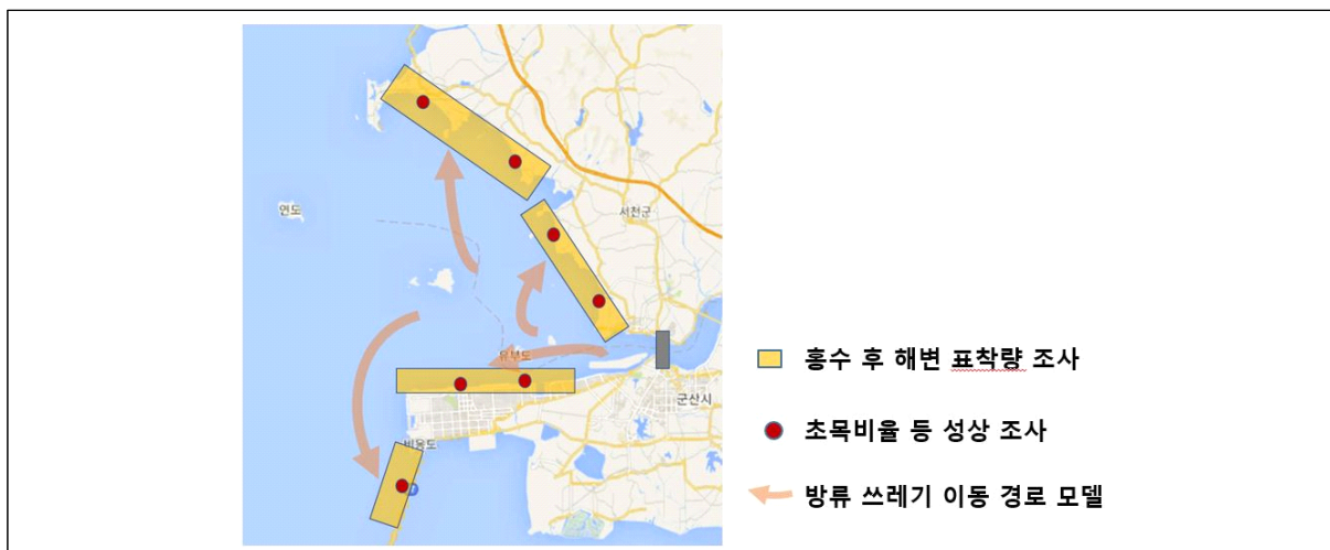
[그림 4-49] 금강하구 수치모델과 쓰레기 이동 후 해변 표착량 조사를 통한 유입량 추정 개념도
