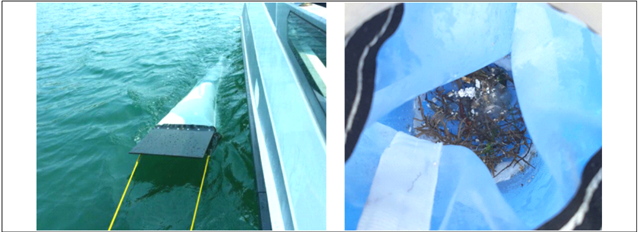
[그림 3-6] 만타트롤을 이용한 부유쓰레기 양 조사 및 추정(단위 해수부피당 쓰레기 무게) (Chris Wilcox, CSIRO)
