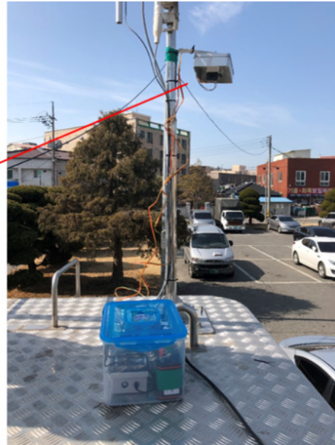
[그림 3.21] 평가에 사용된 광산란법 PM10 센서 및 현장 설치 모습
