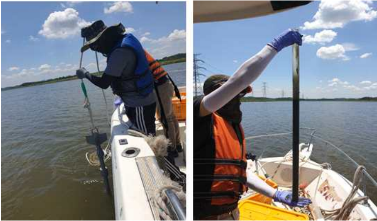
[그림 4-2] 주상퇴적물 채취 장면(좌)과 채취된 주상퇴적물(우)
