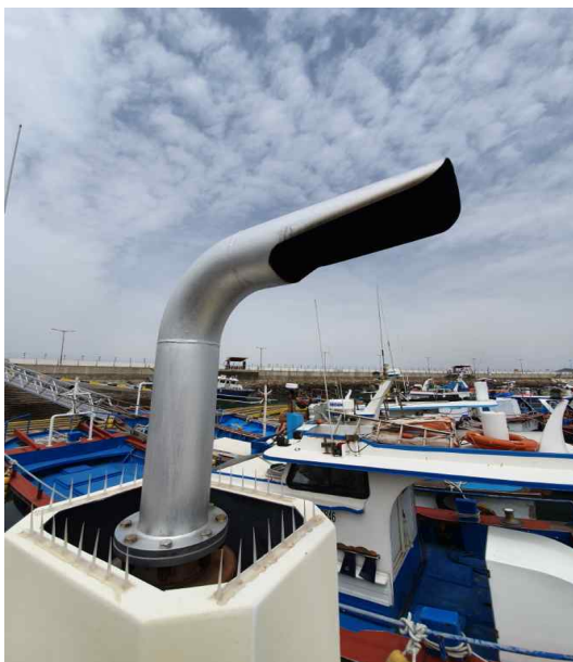
[그림 10] 측정대상 선박에 대한 배출구 조사 모습
