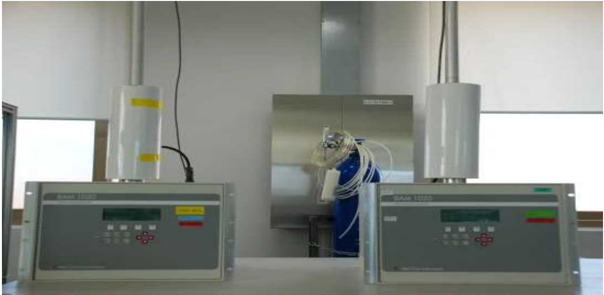
[그림 2.17] 미세먼지 측정기 상부에 가열 히터가 장착된 모습
