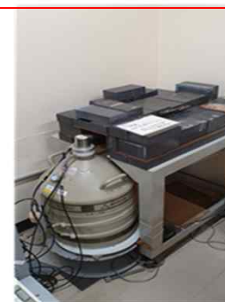
방사화 분석을 위한 교토 대학교 HPGe 감마선 분석 시스템
