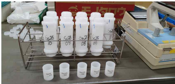
방사화 분석을 위한 조사 준비 중인 에어로졸 시료의 모습
