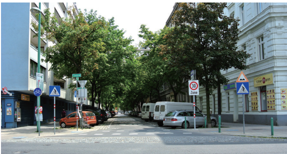
▲ 고원식 횡단보도를 조성하여 이면도로의 통행 속도를 30km/h로 줄인 생활 가로 조성(빈)
