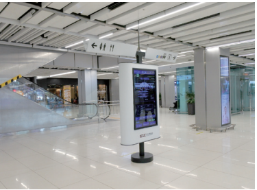
▲ 이용객 시야 및 낮은 천장 높이를 고려하여 각진 형태의 안내사인 시스템을 도입한 김포공항
