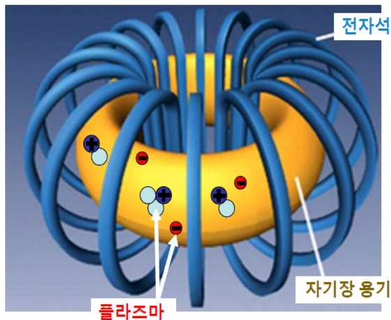
그림 67 토카막 장치의 기본 원리 (자기장과 플라즈마)
