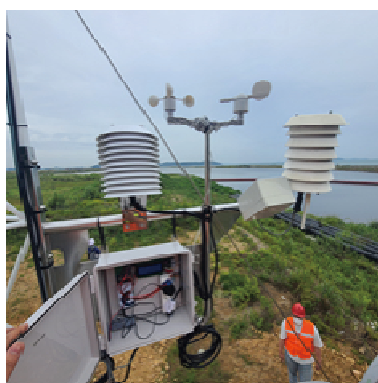
[그림 4.40] 당진화력발전소 저탄장 배출량 조사를 위한 측정기 운영 전경
