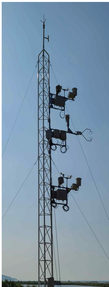
[그림 4.40] 당진화력발전소 저탄장 배출량 조사를 위한 측정기 운영 전경
