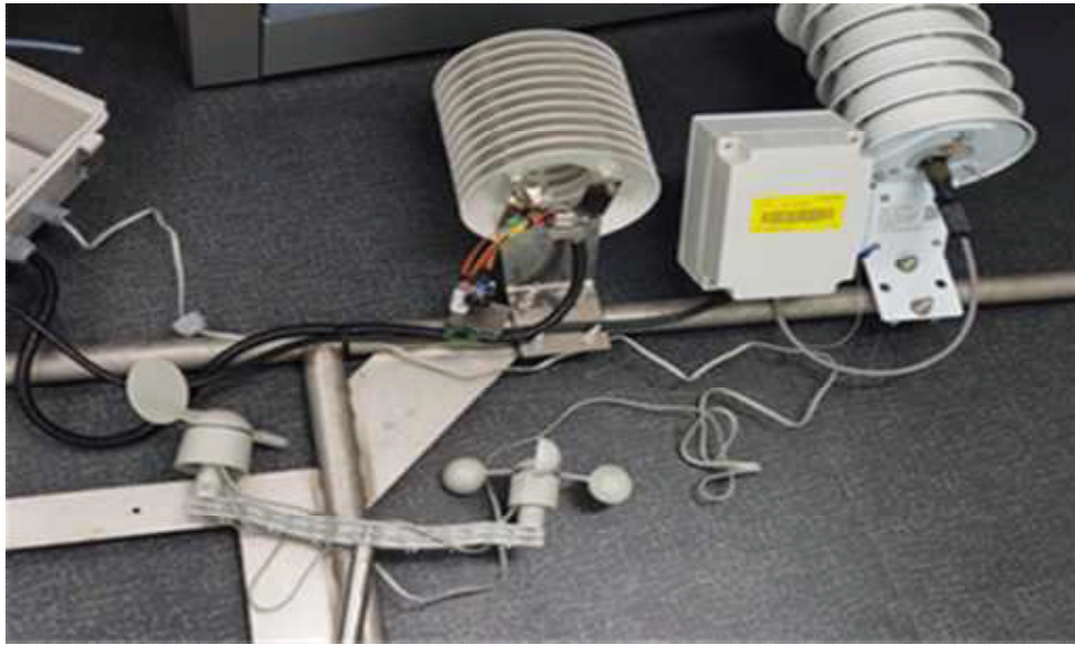
[그림 4.24] 기상 측정 장비 연결 모습
