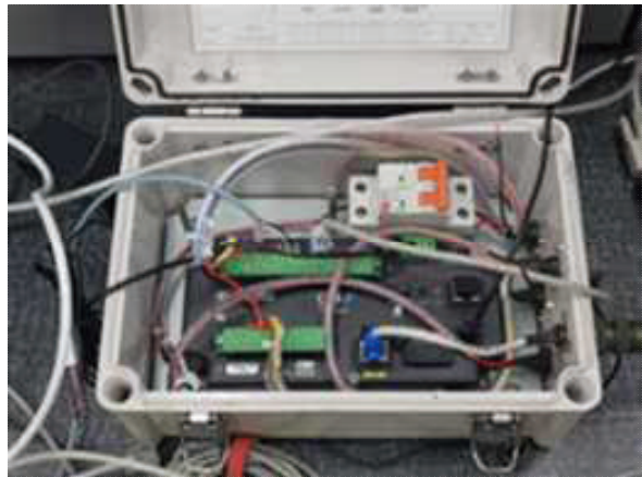
[그림 4.25] 아두이노 보드 및 데이터로거 연결 모습
