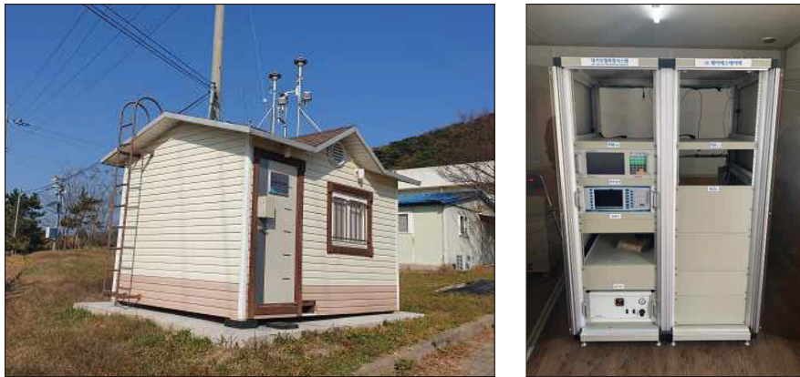
[그림 3.4] 대난지도 측정소 전경 및 측정장비
