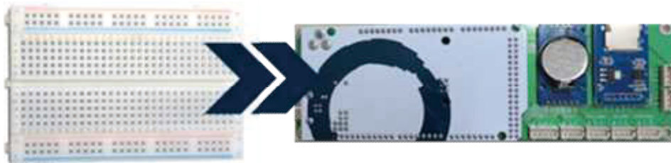
[그림 4.16] 측정장비 메인보드 PCB판넬로 교체
