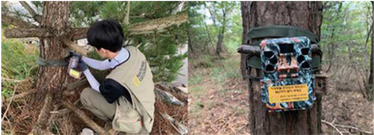
[그림 4.19] 무인센서카메라 설치 모습과 설치된 무인센서카메라(Browning BTC-6XD)
