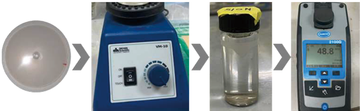
[그림 3.6] 탁도계를 이용한 탁도 분석
