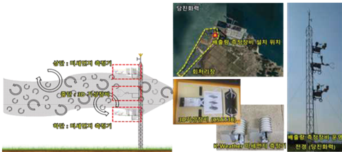
[그림 5.6] 회처리장 Flux 배출량 조사 모식도
