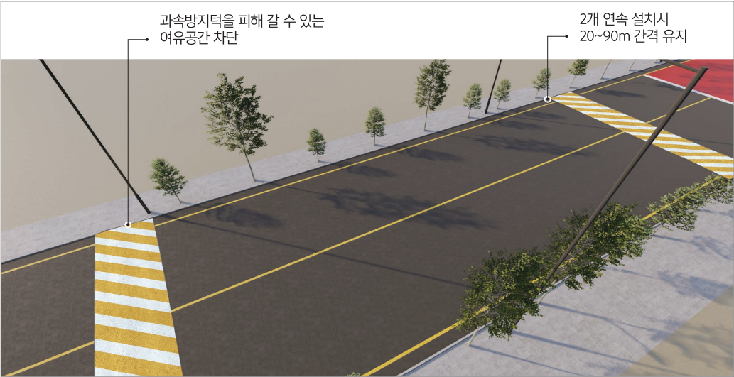
▲ [그림 4-17] 과속방지턱 설치 기준 2
