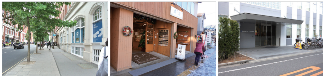
▲ [그림 3-20] (영국/일본) 단차를 해소하기 위해 전면공지에 경사로 설치
