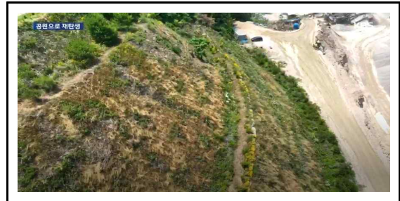
그림 12. 녹생토공법으로 복구한 채석장 절개면 출처 : KBS뉴스 뉴스7(광주)(2024.06.18.) 방송화면캡처.
